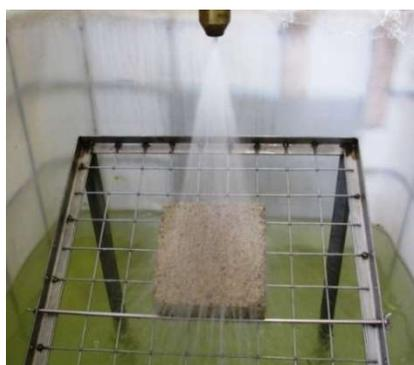
Figura 6 – Bloco de concreto sendo submetido ao teste de degradação.
