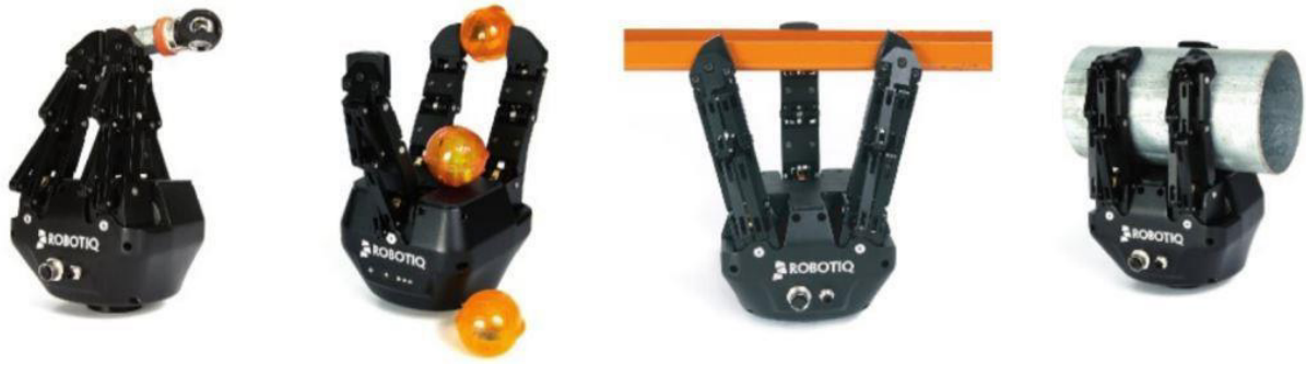
4. ábra: A Robotiq háromujjas megfogójának fogástípusai
