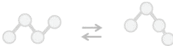
Figure 11 : Schéma représentant le mouvement de type III, correspondant à la rotation autour d'une simple liaison. Ici, le schéma met en évidence le passage d'un état trans vers un état gauche +. Ce schéma inspiré de la représentation faite par E. Helfand [82].
