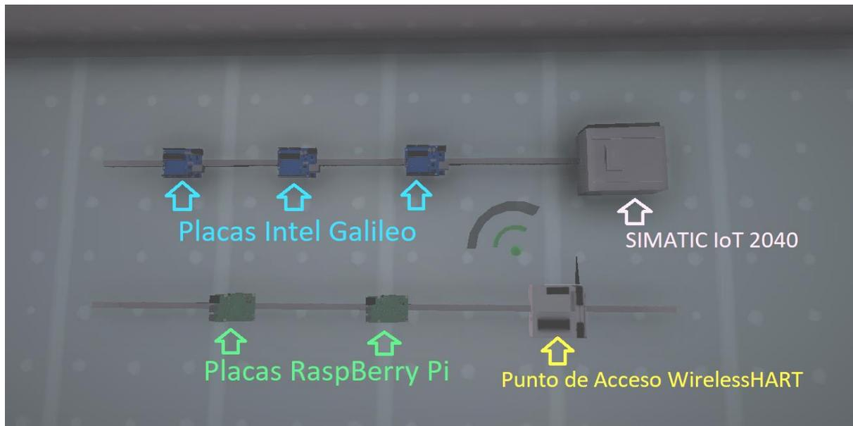
*Figura 6.1.* Nombres de los dispositivos del banco de pruebas de la estación principal
