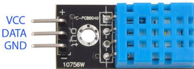
Figura 8 - sensor DHT11 con pcb
