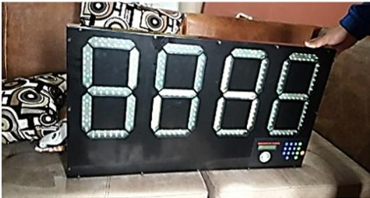
Figura 2. Estructura Finalizada, Arduino y relé. Elaboración propia
