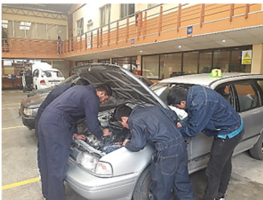
Figura 3. Ajustando el punto de encendido. Elaboración propia
