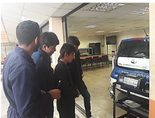
Figura 4. Tomando las muestras de los gases de escape. Elaboración propia
