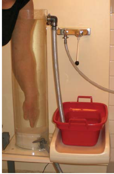
Figura 1.2: Proceso de obtención del volumen por desplazamiento de agua
