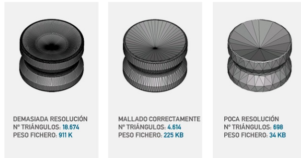
Figura 4.1: Resolución variando el número de triángulos de un archivo STL
