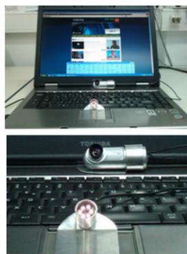
*Figura 18: Control del ordenador a través de los movimientos oculares*
