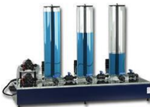
Figura 4.1 - Processo de três tanques AMIRA DTS 200.
