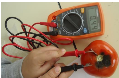
Figura 5.51: Medição da d.p. e da intensidade de corrente de pilhas biológicas. Cálculo da potência máxima fornecida.
