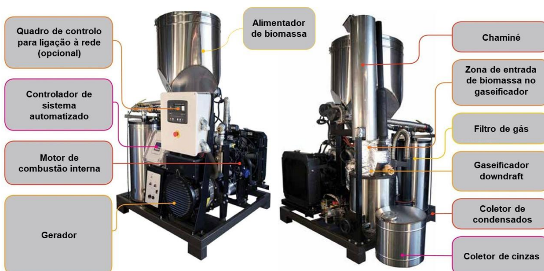
Figura 2.4: Esquema do gaseificador de leito fluidizado (adaptado da ficha técnica do gaseificador PP20 Power Pellet ).
