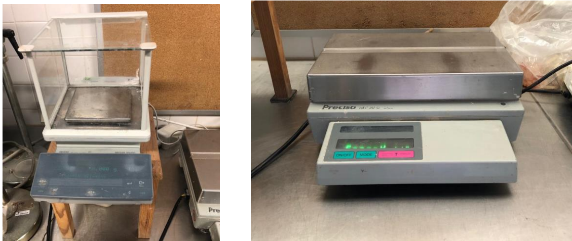
Figura 3.3 - Balança digital precisão 0.001g (esq.), Balança digital precisão 0.1g (dir.)
