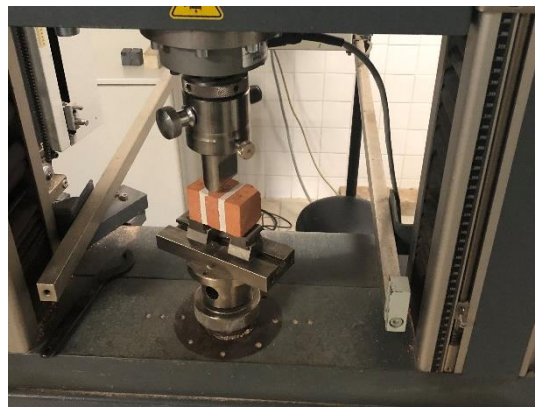
Figura 3.14 - Provetes após ser colocada a fita adesiva (esq.), Proвете a ser ensaiado na máquina de ensaio "ZWICK Z050" (dir.)
