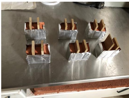
Figura 3.14 - Provetes após ser colocada a fita adesiva (esq.), Proвете a ser ensaiado na máquina de ensaio "ZWICK Z050" (dir.)
