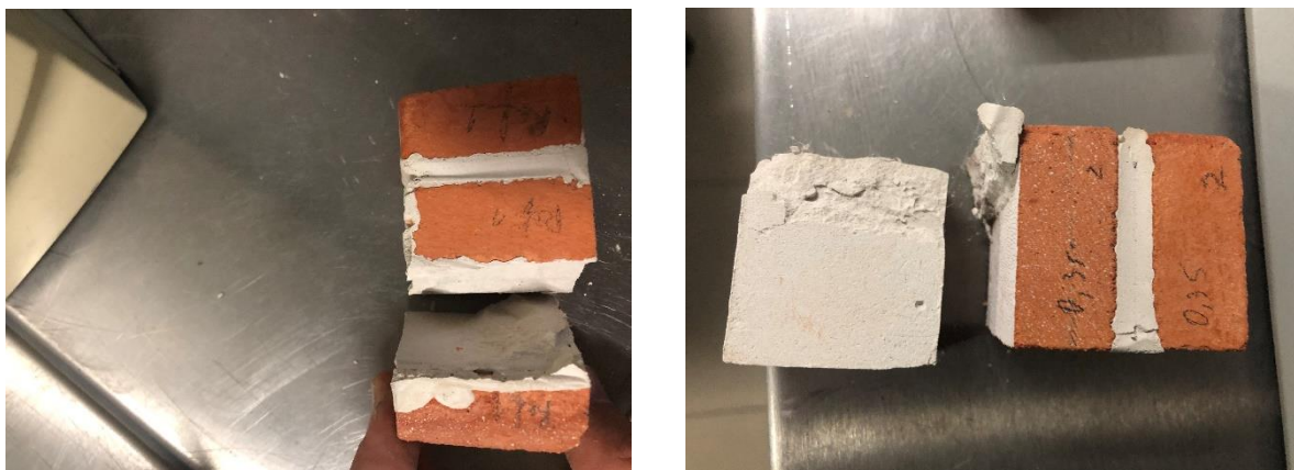
Figura 4.22 - Provetes após ensaio de aderência, os provetes aqui representados são o de ref.(esq.) e o 0.35g (dir.) de QF
