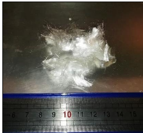
Figura 2.3 - 1.5g de fibras de polipropileno [7]
