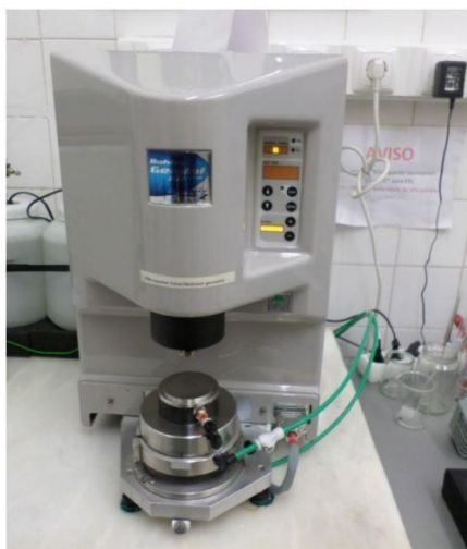
Figura 3.4 - Reómetro rotacional Gemini HR nano da Bohlin Instruments (Malvern, UK)
