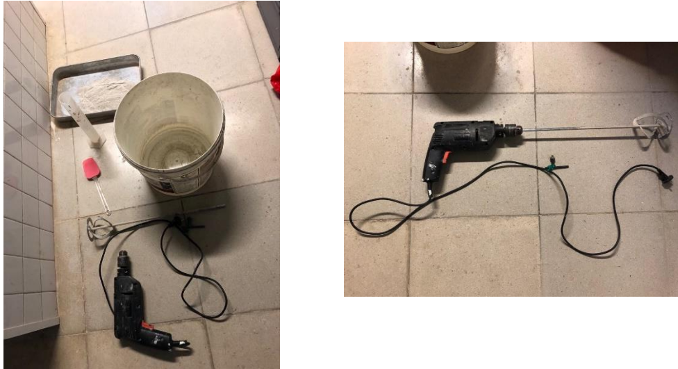
Figura 3.1 - Material utilizado para a amassadura (esq.), Berbequim + haste helicoidal (dir.)
