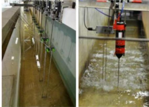
Figura 4.2: Estrutura móvel de 8 sondas de nível (esquerda) e sonda ADV e de nível (direita). Adaptado de Conde et al. (2012).
