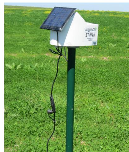
Figura 6- Sonda de monitorização da umidade do solo
