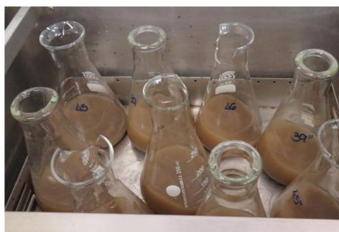
Figura 3- Agitação das amostras de solo
