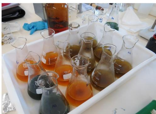
Figura 4- Reação do Dicromato de Potássio nas amostras de solo
