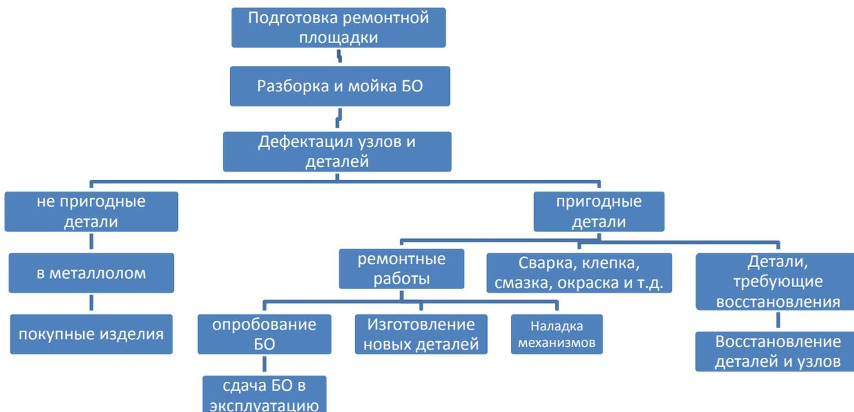
Рисунок 2 - Структура ремонтного процесса бурового оборудования
