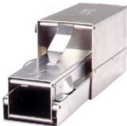
Figura 1 - Esquema de uma armadilha Longworth (Sibbald, Carter & Poulton 2006)
