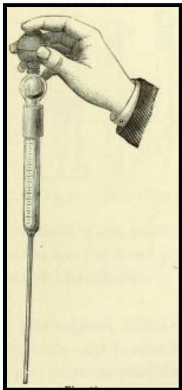
Figura 17: Cuentagotas con pera de caucho con agujero para toma de sucesivas muestras (Limousin, 1878)
