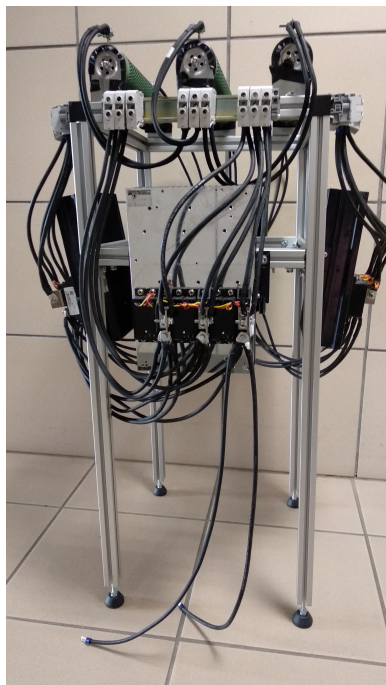
Figura 2.8: Fotografía del OLTC de la red de distribución a escala
