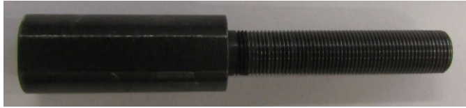
Figura 3-12. Adaptador portaherramientas a rótula
