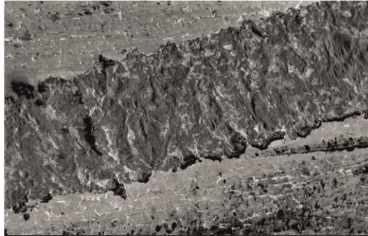
Figura 1-12. Huella de contacto entre dos hilos de acero inoxidable.
