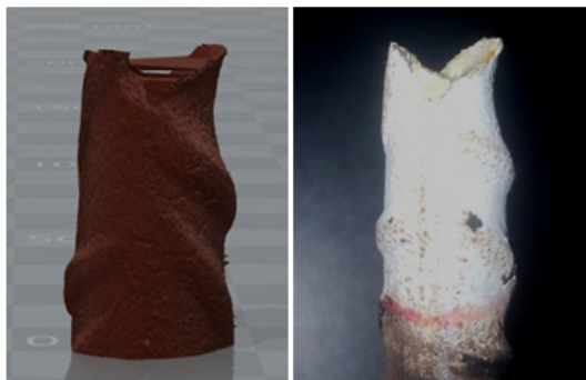
Figura 5. A la izquierda modelo escaneado de la barra mostrada en la imagen de la derecha.
