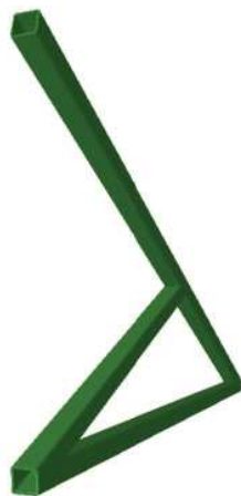
Cercha compuesta por perfiles SHS./ Imág. Cype 3D
