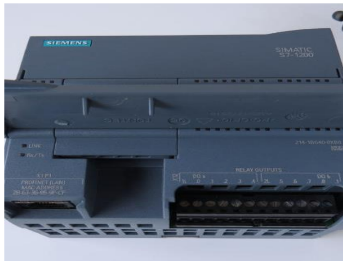
Figura 2-5. Salidas PLC Siemens
