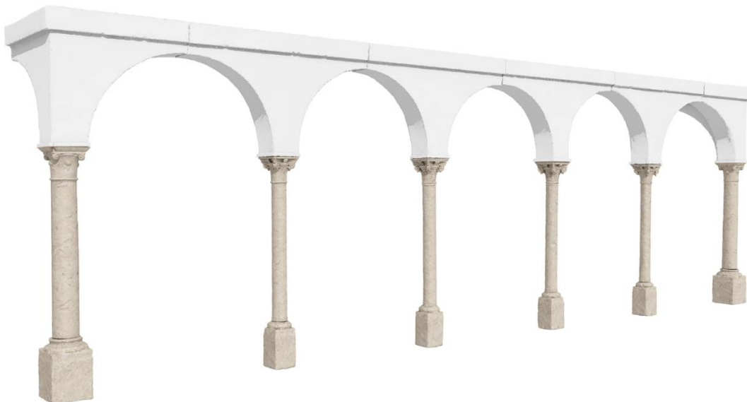
Figura 33. Reconstitución digital en el modelo HBIM. Arcos y columnas de la galería sur del Cenador de Carlos V. Fuente: (Antón et al. , 2018).
