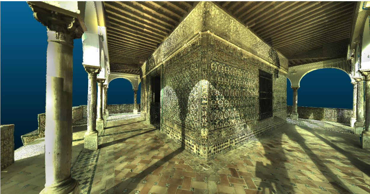
Figura 17. Nube de puntos RGB del Cenador de Carlos V. Perspectiva en ojo de pez de las galerías sur y este. Fuente: propia basado en datos TLS con la colaboración de José Antonio Barrera y Enrique Nieto.
