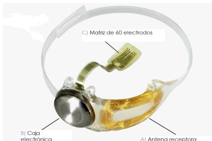
Figura 13.- Ilustración de los tres componentes internos del dispositivo Argus® II Retinal Prosthesis System (modificada de da Cruz et al., 2016)
