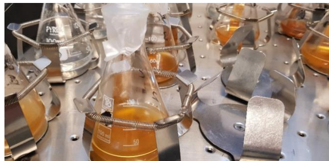
Figura 8. Proceso de incubación de las fases digestivas a 37°C en el agitador orbital. Realizado por el propio autor.
