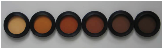
3.1. ábra Az XRF mérőkészülék kalibrációjához kiválasztott hegesztési füst minták mélyülő színük (növekvő tömegük) szerint sorbarendezve
