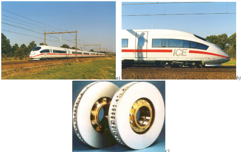
1.4. ábra — Az ICE gyorsvonatok (a)(b) normál üzemben 300 km/h sebességgel száguldanak. Az ICE2 gyorsvonat AISi7Mg ötvözet alapú SiC részecskéket tartalmazó fémmátrixú kompozitból készült fékrotorjai (c) segítségével lehet megállítani a súlyos szerelvényt (az anyagot a Duralcan gyártja). Egy öntöttvasból készült fékrotor 140 kg tömegű rugózatlan tömeget jelent, míg a kompozit alkatrész már csak 76 kg, így az egy vagonon lévő 8 fékrotoron már jelentős tömegcsökkentést lehet elérni. Ilyen úgynevezett sűrűláda kompozitokat gyártanak mind fémmátrixú, mind kerámiamátrixú kompozitokból, és fő alkalmazási területük a könnyű és nagyon hosszú élettartamú fekerendezések fejlesztése. [2], [7], [8]
