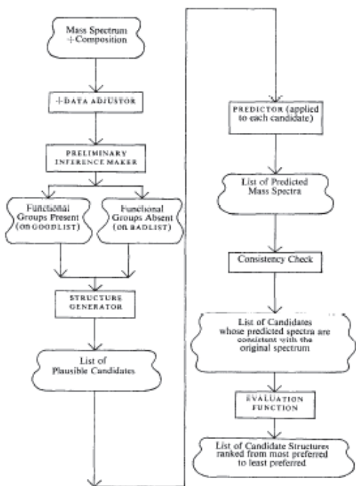
10. ábra. A tömegspektrumok értékelésére kidolgozott HEURISTIC DENDRAL szakértői rendszer folyamatábrája. [79]
