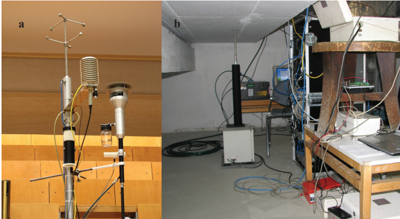
23. ábra: Az Ortvyay Rudolf előadóteremben elhelyezett szenzorok és mintavevő csövek (a), valamint a mérőműszerek elhelyezése a terem alatti raktárban (b).
