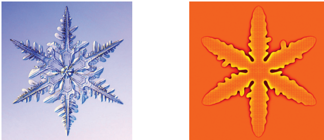
1.4. ábra. Jellegzetes dendrites szerkezetű 2D jégkristály mikroszkópos felvétele [26] (balra), és 2D dendrit atomisztikus fázismező szimulációiban (saját számolás jobbra)
