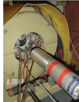
5.3. ábra: Nyolc darab bizmut-germanát (BGO) szcintillátor detektor, a Compton-szórást szenvedett fotonokat detektálják.
