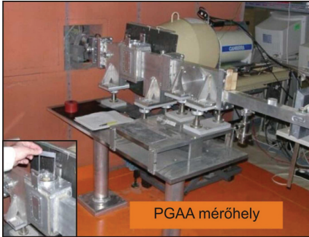
5.2. ábra: Az MTA IKI PGAA mérőhelye, a Ge-detektossal (HPGe), bizmut germanát szcintillátorral (BGO) és a mintatartó kamrával.
