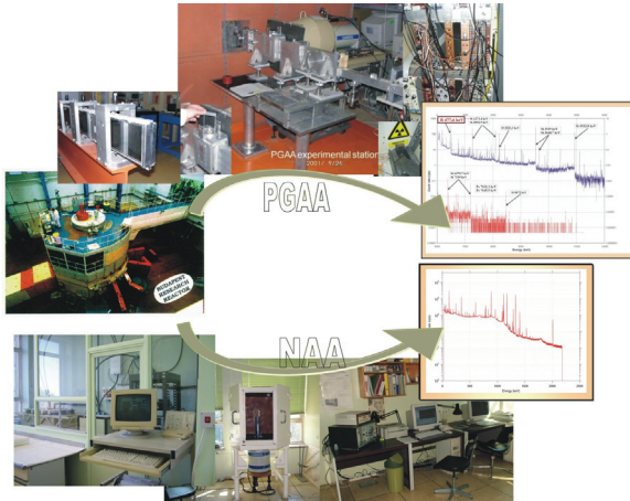
5.5. ábra: A PGAA és az NAA mérések menete a reaktortól a spektrumokig. PGAA esetén a neutron besugárzás a reaktoron kívül, a \gamma -fotonok detektálásával egy időben történik és egy bonyolult, több száz csúcsból álló spektrumot kapunk. NAA esetén a besugárzás a reaktor aktív zónájában megy végbe. A \gamma -fotonok detektálása a besugárzást követően kisháttérű kamrában zajlik. A felvett spektrum néhány tíz csúcsból áll.
