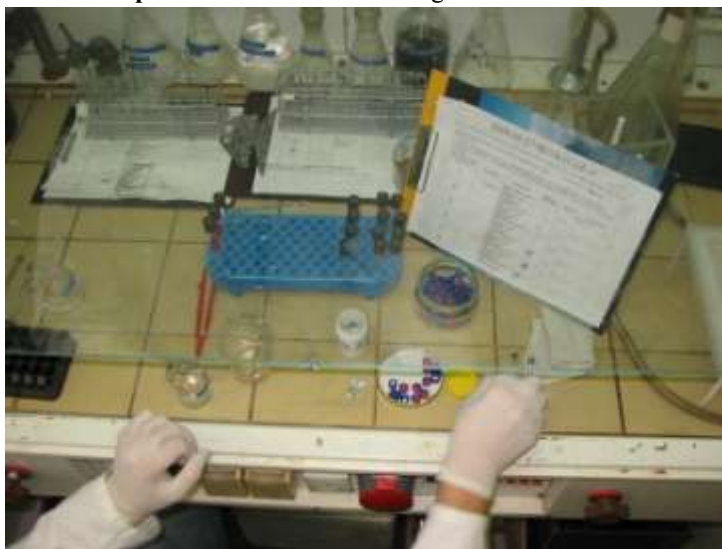
19. kép A származékolt minták hígítása a mérés előtt 1.
