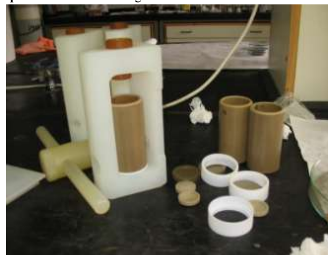
4. kép A mikrohullámmal segített extrakcióhoz használt teflonedények
