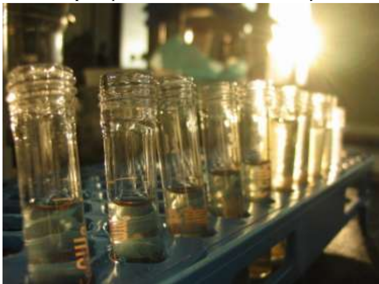
15. kép Reakcióedényekben bepárolt minták
