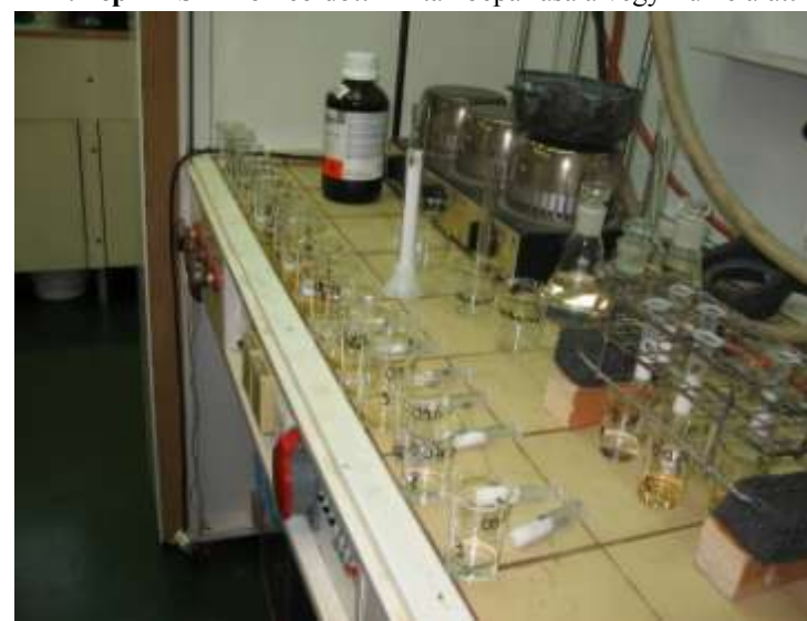
12. kép Az SPE-ről leoldott minták bepárlása a vegyi fülke alatt
