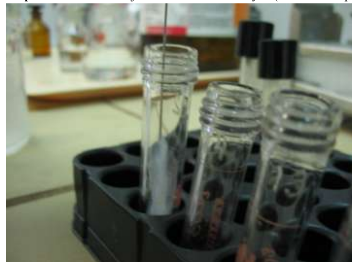
16. kép Trifluor-ecetsav injektálása a reakcióedénybe (származékképzés)
