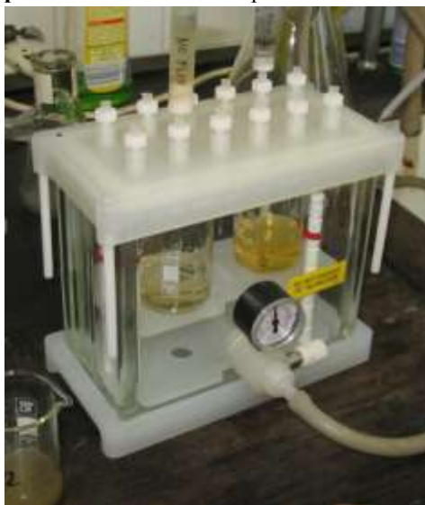
11. kép OASIS HLB SPE oszlopokról a minták leoldása
