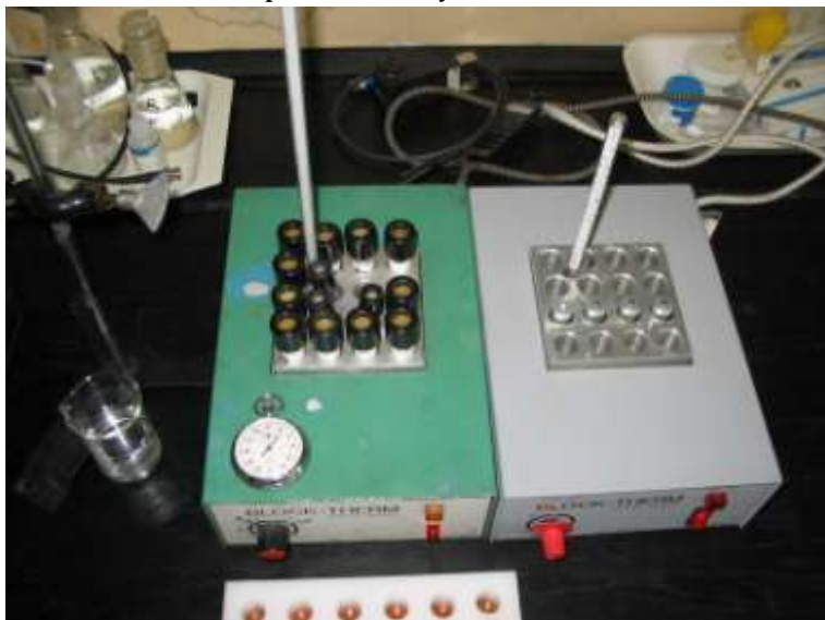
19. kép A származékolt minták hígítása a mérés előtt 1.
