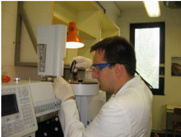
23. kép Hosszas mérést követően szükséges septum- és insertcsere
