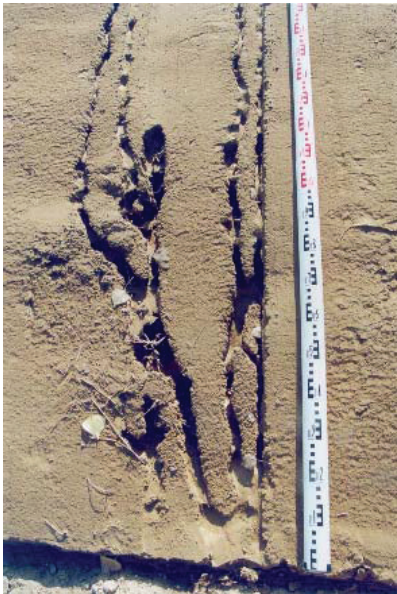
2 kép. Mesterséges esőztetés hatására kialakult barázdák döngölt löszön, 25% lejtésnél
