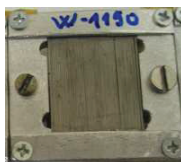
5.1. ábra. Alumínium mintatartó a 0,5mm átmérőjű volfrám huzalokkal
