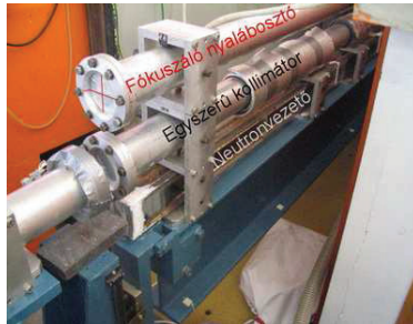
4.1. ábra. A 3 opciós kollimátor rendszer a mozgató mechanikával együtt
