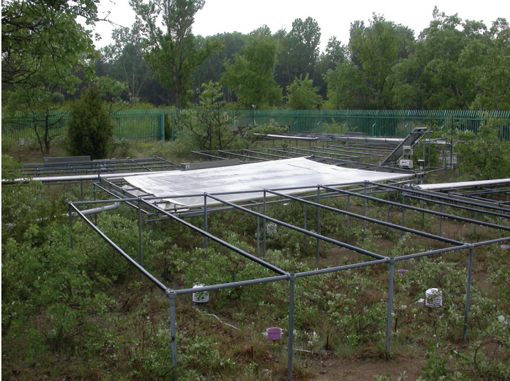
III.5. kép. A fülöpházi klímaszimulációs kísérleti állomás egy részlete esőben, csapadékkizárás idején. Előtérben egy kontroll, mögötte egy szárazságkezelt parcella kihúzódnak esőárnyékoló fóliával. (Kalapos Tibor felvétele)
