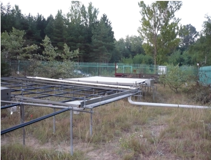
III.4. kép. A fülöpházi klímaszimulációs kísérleti állomás egy részlete hajnalban. Előtérben egy szárazságkezelte, mögötte egy hőkezelt parcella kihúzódtott hővisszaverő fóliával.
