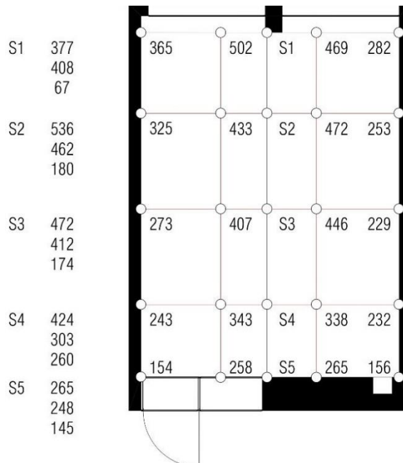
Slika 28: Meritev osvetljenosti zjutraj, 7:25, ob oblačnem vremenu, z lučmi; povprečna osvetljenost brez vrednosti ob oknih in stenah je 406,50 lux
