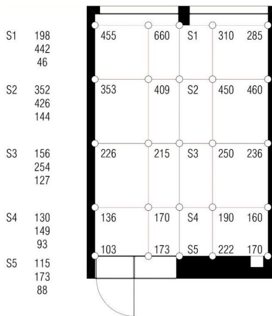
Slika 32: Meritev osvetljenosti popoldne, 14:40, ob oblačnem vremenu, brez luči in s senčili; povprečna osvetljenost brez vrednosti ob oknih in stenah je 280,66 lux
