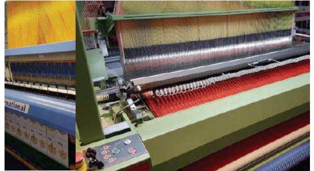
Imagen 14. Telares de etiquetas Mei y Müller (Fuente: fotografías tomadas en la ITMA 2019)
