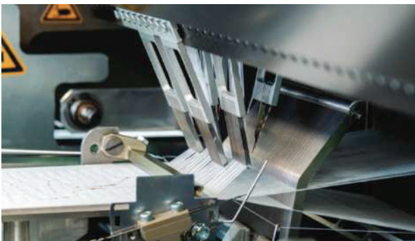
Imagen 12. Jakob Müller NFM® 53 2/84 MDW® (Multi Directional Weaving) telar de agujas con unidad especial de desplazamiento (Fuente: https://www.mueller-frick.com )
