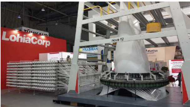
Imagen 13. Lohia Corp Circular Looms. Telar circular de calada para producir tejido tubular (Fuente: fotografía tomada en la ITMA 2019)
