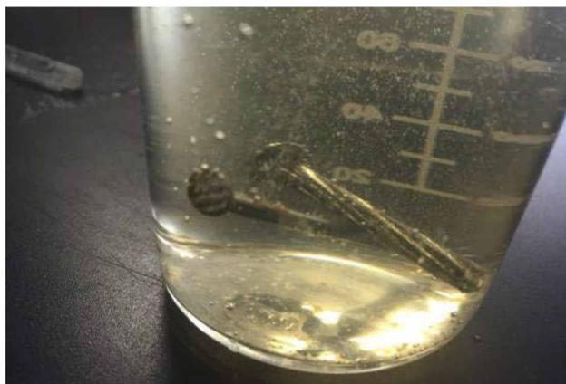
**Figura 6.** Clavo de acero al carbono unido a clavo galvanizado en presencia de un medio salino. El clavo con la capa rica en zinc, protege al clavo de acero. Ejemplo de un sistema de Protección Catódica
