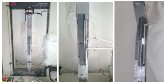
Figura 2. Ensayo a tracción de FRCM
