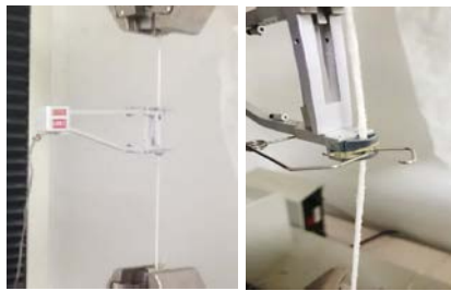
Figura 1. Ensayo a tracción de los hilos
