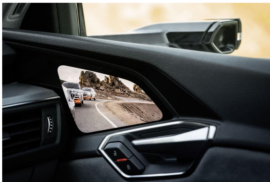
Figura 6.12. Sistema de retrovisors amb càmeres de l'Audi E-tron.
