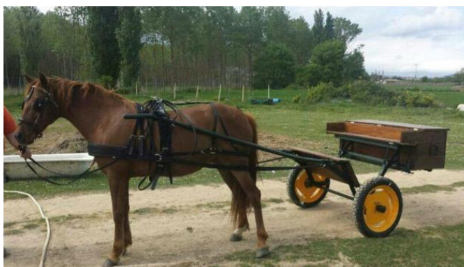
Figura 4.1. Banqueta en la muntura d'un carruatge sense elements ergonòmics ni de seguretat.
