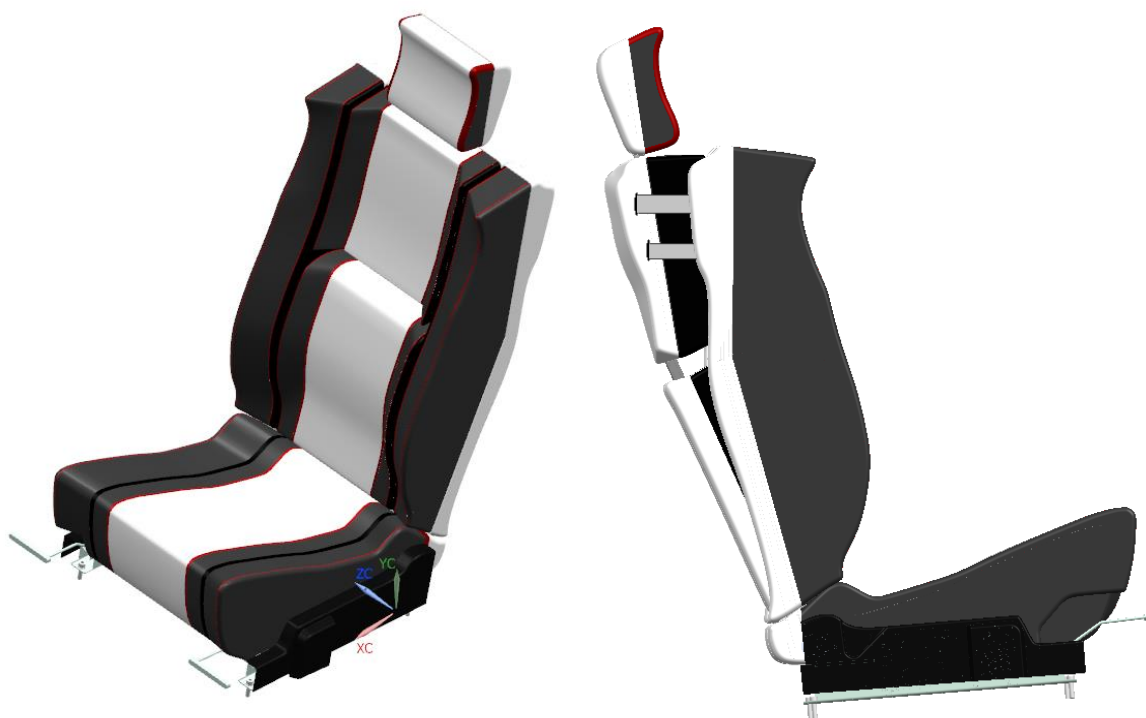
Figura 7.1. Model complet del seient dissenyat a l'esquerra i situació de tensió dels cinturons a la dreta.
