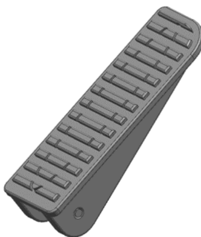
Figura 9.9. Palanca d'accionament de l'accelerador del tipus taula.
