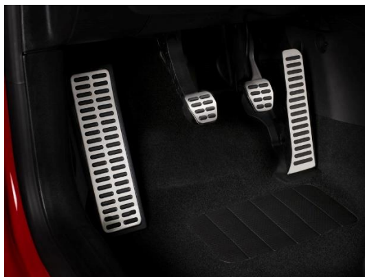
Figura 4.15. Sistema de pedals amb accelerador de tipus taula.
