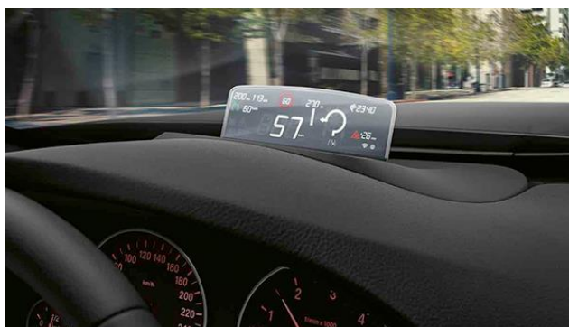
Figura 4.14. Head up display capaç d'utilitzar la tecnologia hologràfica per mostrar informació.
