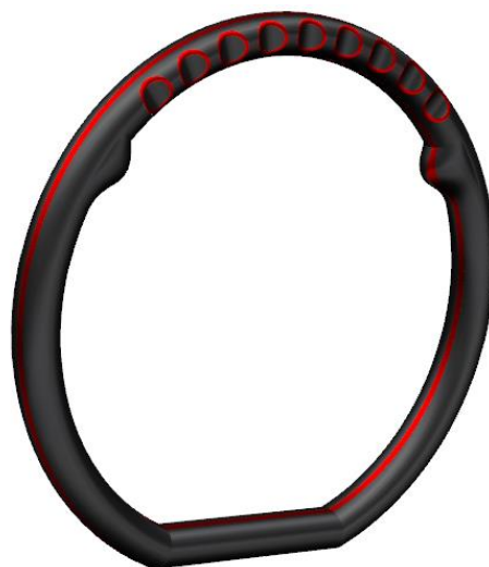
Figura 8.3. Circumferència del volant amb radi retallat i empenyadures.
