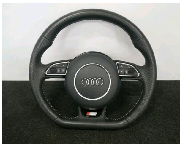
Figura 4.8. Volant circular retallat amb entapissat i elements de control multimèdia
