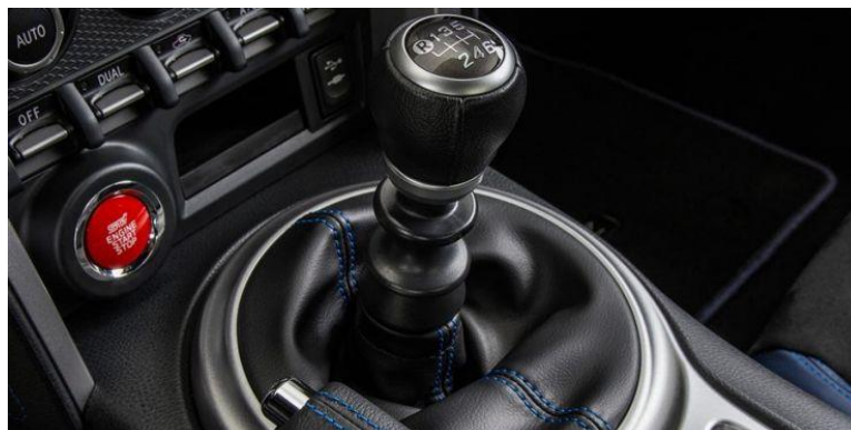
Figura 4.17. Canvi de marxa curt amb poka-yoke d'anella per la marxa enrere
