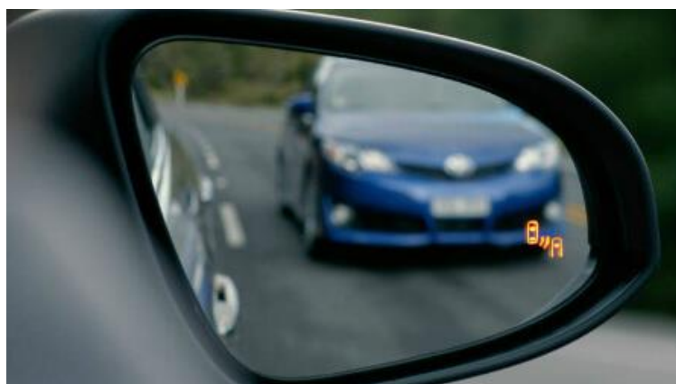
Figura 6.10. Indicador de cotxe en l'angle mort il·luminat en taronja. Model de la marca Toyota.
