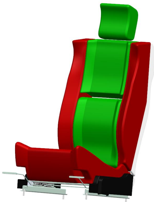
Figura 7.2. En verd les parts mòbils del seient i en vermell les fixes.
