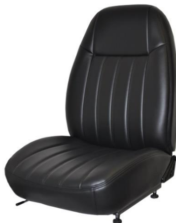
Figura 4.2. Banqueta d'automòbil amb primitius elements ergonòmics i amb manca d'elements de seguretat.
