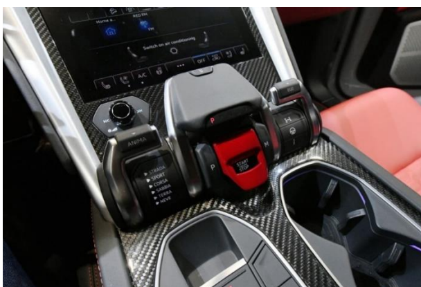
Figura 4.20. Canvi de marxes per botons amb poka-yoke per a la marxa enrere.
