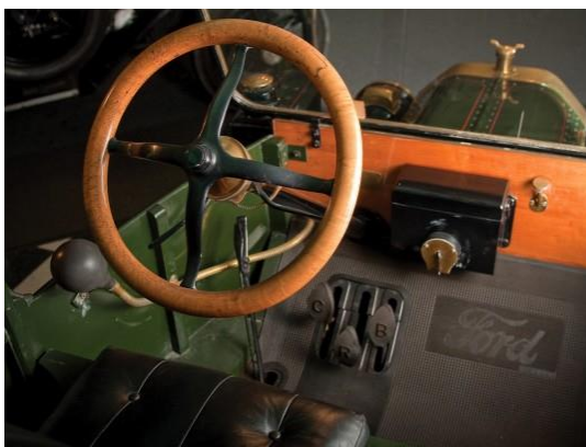
Figura 4.6. Volant llis sense empenyadures ni radis de circumferència variables
