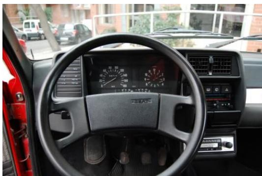
Figura 4.10. Quadre de comandaments amb elements analògics
