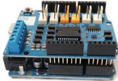
Imagen 4.3.9: Motor Shield apilado a la placa Arduino UNO.
