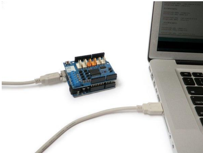
Imagen 4.3.2: Conexión del Motor Shield al ordenador para el programado
