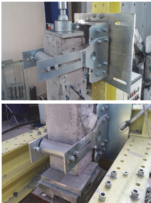
Slika 10. Točka nanošenja uzdužnog opterećenja (gore) i kliznih oslonaca na krajevima uzorka (dolje)
