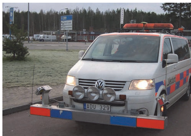
Slika 1. Laserski sustav za snimanje stanja ceste (Izvor: Svenson [17])
