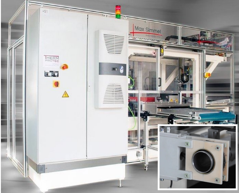
Abb. 3: Rolltronic mit integrierter Induktionseinheit zur partiellen Bauteilerwärmung (Ausschnittsvergrößerung) [1]
