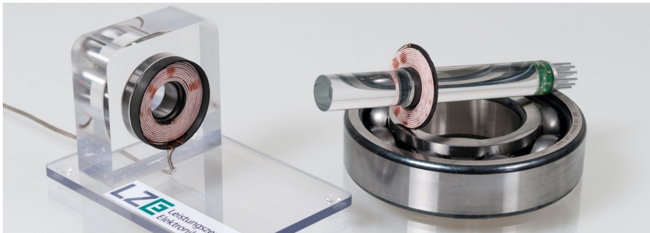
Abbildung 3.11: Foto des Kugellagers mit integriertem IPT-System [96].
