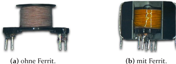
Abbildung 4.19: Gewickelte RM6-Spule mit Coilformer.
