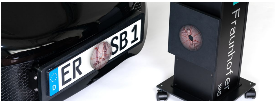
Abbildung 3.10: Foto des Ladestationssystems mit integriertem IPT-System [95].
