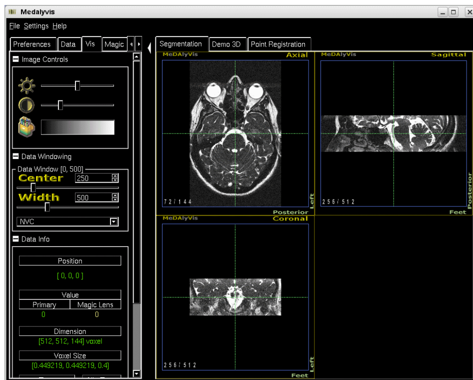
Abbildung 18: Medalyvis beim Starten des Programms. In der linken Spalte der Bedienoberfläche befinden sich alle Funktionen für die Segmentierung, Registrierung und Visualisierung. Der rechte Bereich dient der Darstellung und Bearbeitung der medizinischen Bilddaten. Im Beispiel ist ein MRT-CISS Datensatz mit 2D-Visualisierung der axialen, koronalen und sagittalen Schnittebenen gezeigt.
