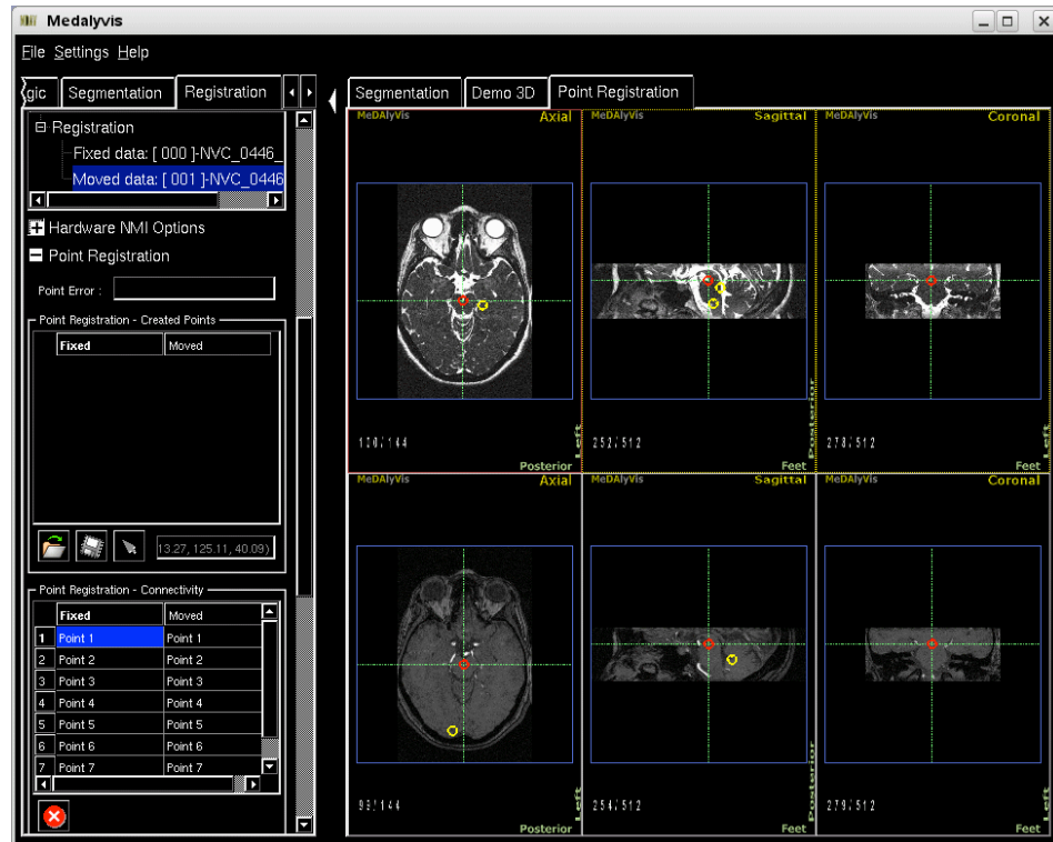
Abbildung 25: Registrierungsmodul von Medalyvis mit geladenem MRT-CISS (oben) und MRT-TOF (unten) Datensatz, korrespondierende Punkte wurden manuell festgelegt, wobei die Software zwischen aktiven (kleine rote Kreise) und eingefroren (kleine gelbe Kreise) Punkte unterscheidet.
