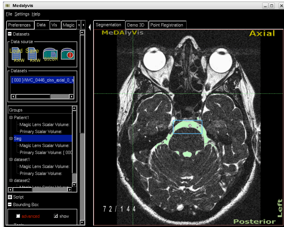
Abbildung 19: Segmentierung des Liquorraums eines MRT-CISS Datensatzes mit der Methode „Volume Growing“. Der relevante Liquorraum wurde mit einer Bounding Box (blaues Rechteck) abschnittsweise begrenzt. Der grün markierte Bereich zeigt das Ergebnis der Segmentierung
