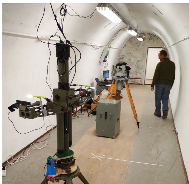
22. ábra | Mérés giroteodolittal a Jánosy Földalatti Fizikai Laboratóriumban a pontos É–D irány meghatározására
