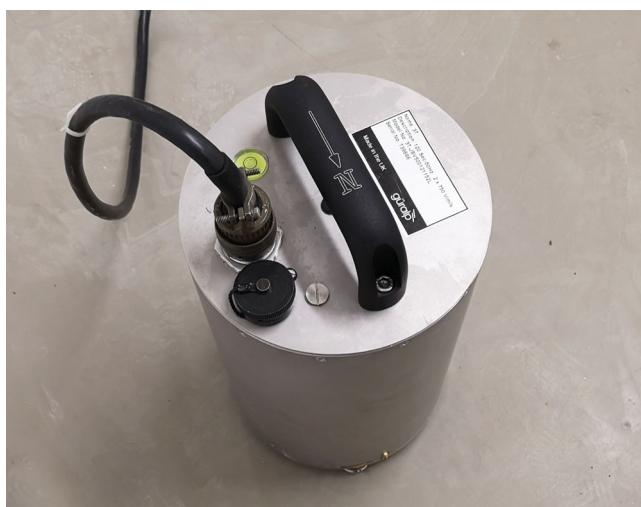
13. ábra | Talajrezgések regisztrálása Güralp 3T 3 tengelyű szeizmográf-fal az inga szomszédságában Figure 13 | Registering microseismic vibrations with Güralp 3T 3-axis-seismograph next to the torsion balance
