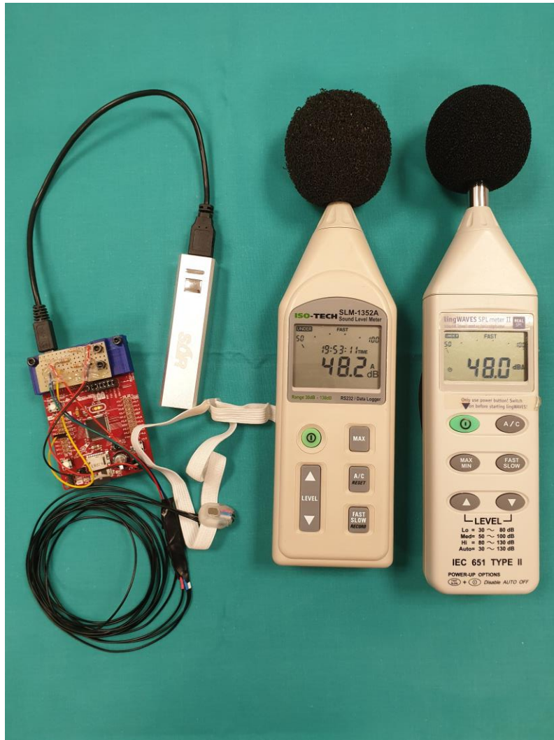
Figura 15: Dispositivos para la medición en la validación de la intensidad relativa. A la izquierda la placa de desarrollo con el microcontrolador elegido para este trabajo, el acelerómetro y la batería, y a la derecha los dos sonómetros.
