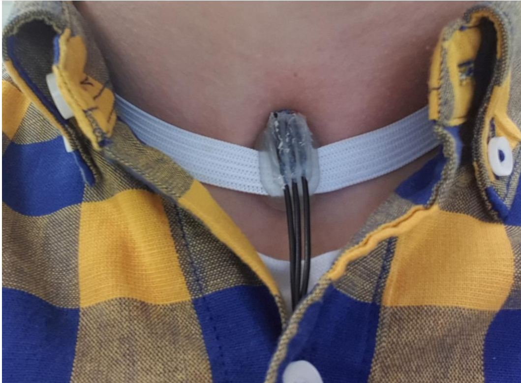
Figura 18: Disposición del sensor sobre la laringe utilizando la pieza detallada anteriormente.
