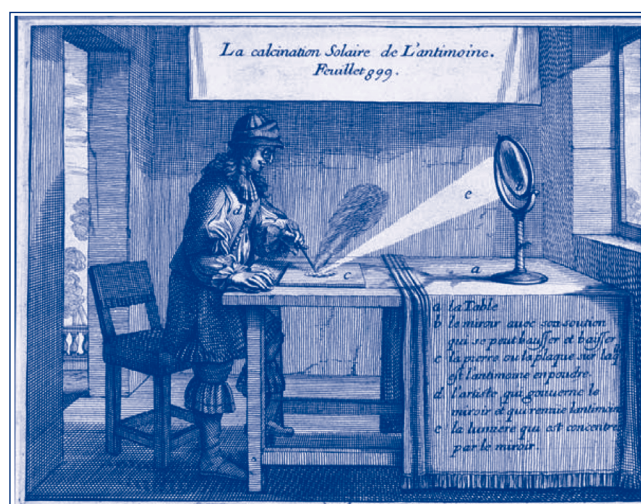
FIGURA 1. La calcination solaire de l'antimoine , aiguafort d'Abraham Bosse per al llibre Traicté de chymie , de Nicaise Lefèvre (1663). Llegendes: a) La taula; b) El mirall amb el seu suport que es pot orientar; c) La pedra o placa sobre la qual es troba l'antimoni en pols; d) L'artista que governa el mirall i que remena l'antimoni, i e) La llum concentrada pel mirall. Reproduït amb l'autorització de la Biblioteca de la Universitat de Barcelona.
